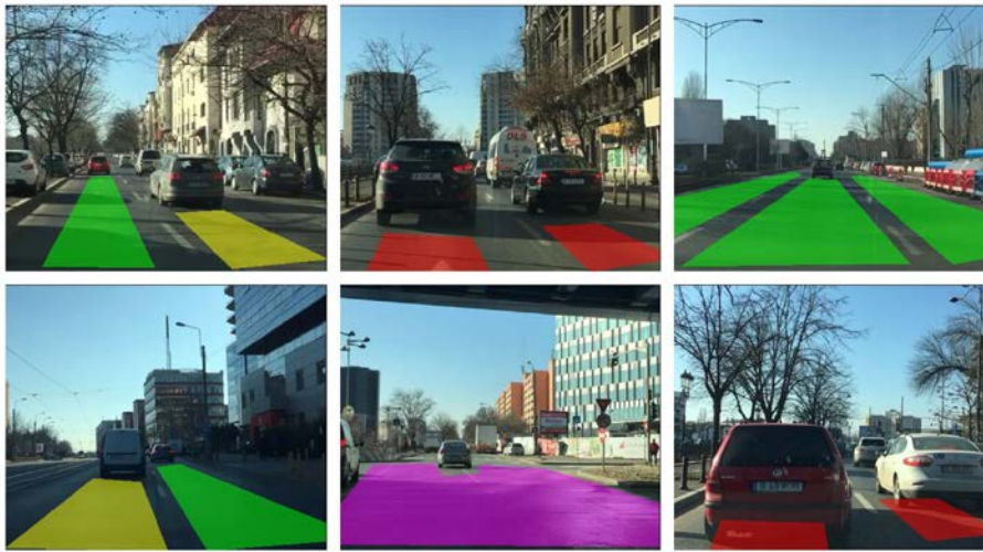
Figura 3.2 Exemple de zone care permit conducerea. Regiunile roz reprezintă „benzi-în-intersecție”, cele roșii sunt benzi „bară-la-bară”, regiunile galbene sunt benzi „ocupate” iar cele verzi sunt benzi „libere”
